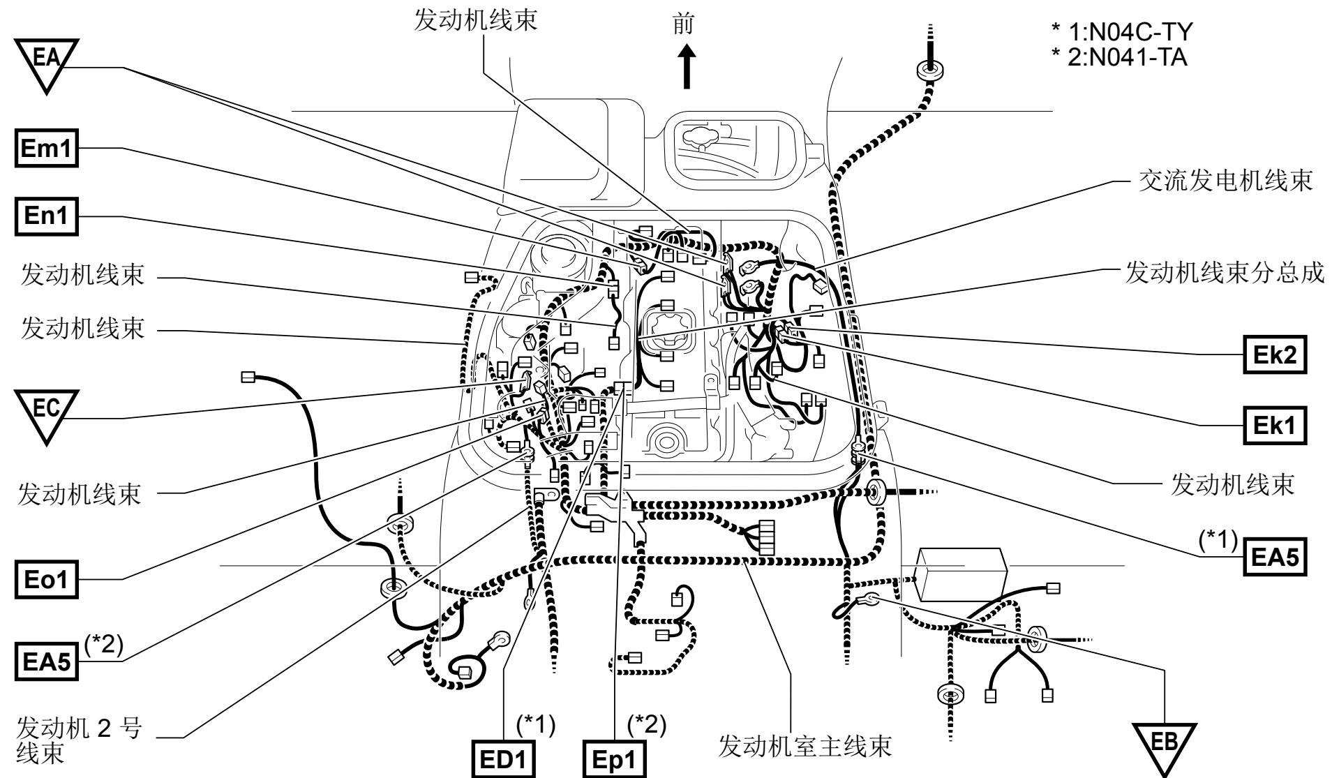
线束和线束、发动机室搭铁点 <N04C-TY, N041-TA>
